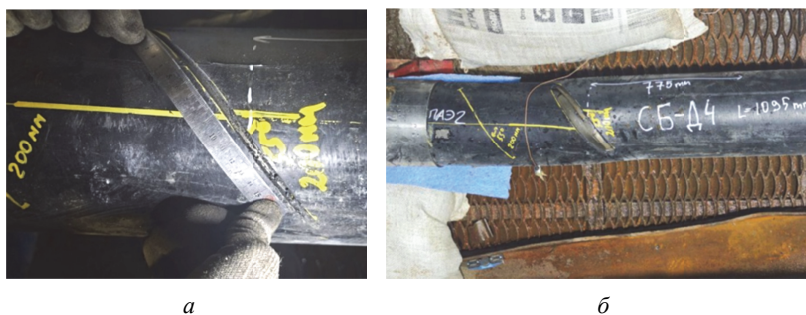
Рис. 4. Образец СБ-Д4 при повторном АЭ-контроле: а – общий вид образца перед испытанием, б – вид разрушенного образца
