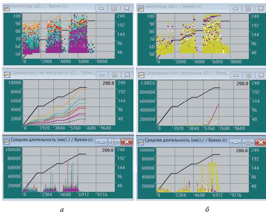
Рис. 3. Графики нагружения (кгс/см 2 ), амплитуд (дБ), суммарного счета импульсов и средней длительности (мкс): а – на каналах 1–11 на верхнем днище и цилиндрической части; б – на каналах 12–14 на границе цилиндрической части и нижнего днища
