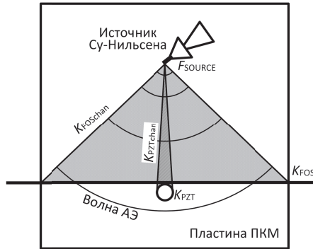
Рис. 4. Схема регистрации АЭ-волн в пластине с помощью локального ПАЭ и ВОД
