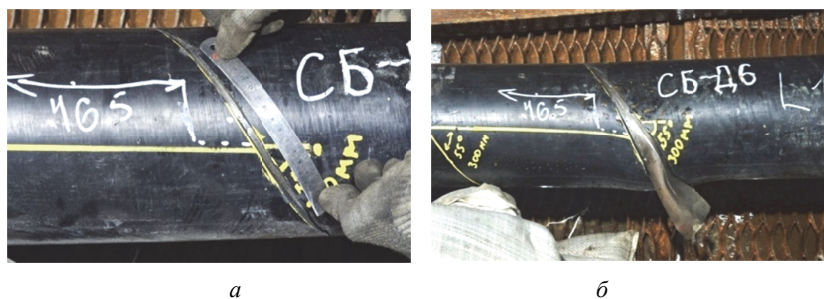
Рис. 6. Образец СБ-Д6 при повторном АЭ-контроле: а – общий вид образца перед испытанием, б – вид разрушенного образца
