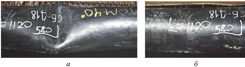
Рис. 10. Образец СБ-Д18 при повторном АЭ-контроле: а – общий вид образца перед испытанием, б – вид разрушенного образца
