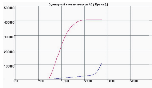
Рис. 10. Зависимость параметров импульсов АЭ от времени при сильном (розовый) и плавно увеличивающемся (синий) пропусках на фланцевых соединениях, расположенных на трубопроводе газа очистки
